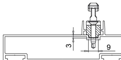
Schema di montaggio spessori di contenimento laterale
