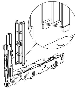
Montage des cales d'adaptation sur la tringle de commande
